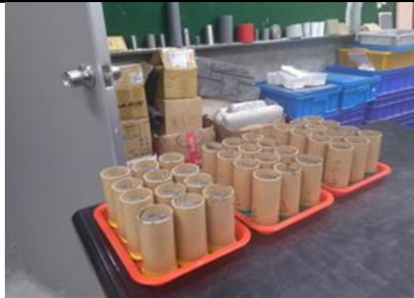
圖 1 試體備製與澆置養護
