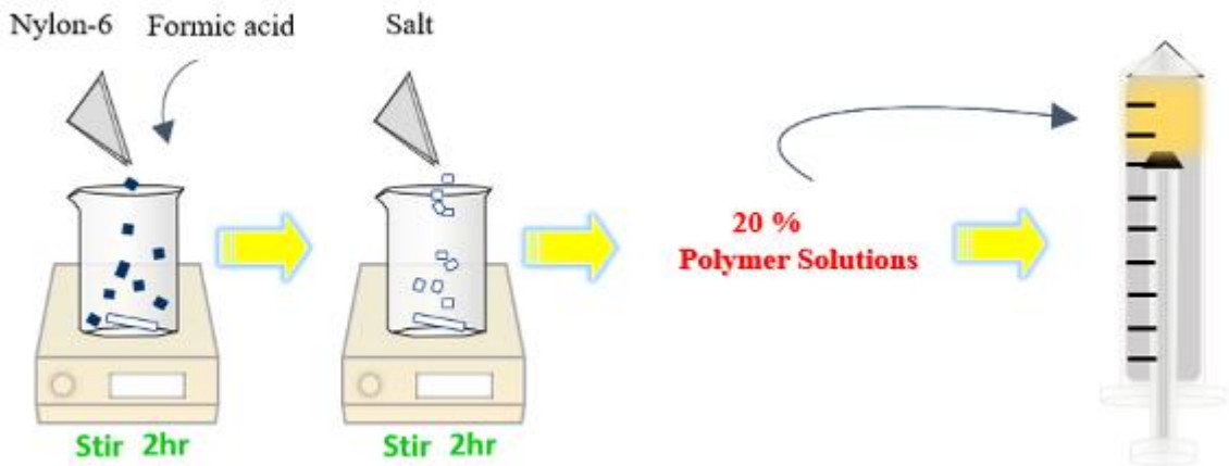
圖 2 紡絲溶液製備流程圖
