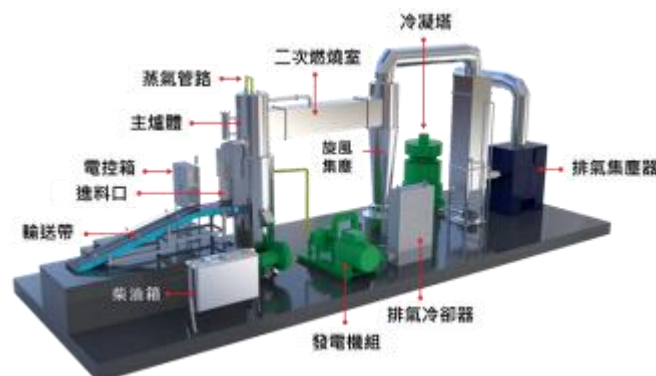
圖1 無煙囪廢棄物衍生性燃料蒸氣產生爐
