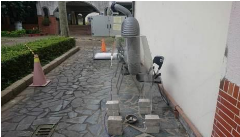
圖 2.3-1 模擬油滴產生器模組
