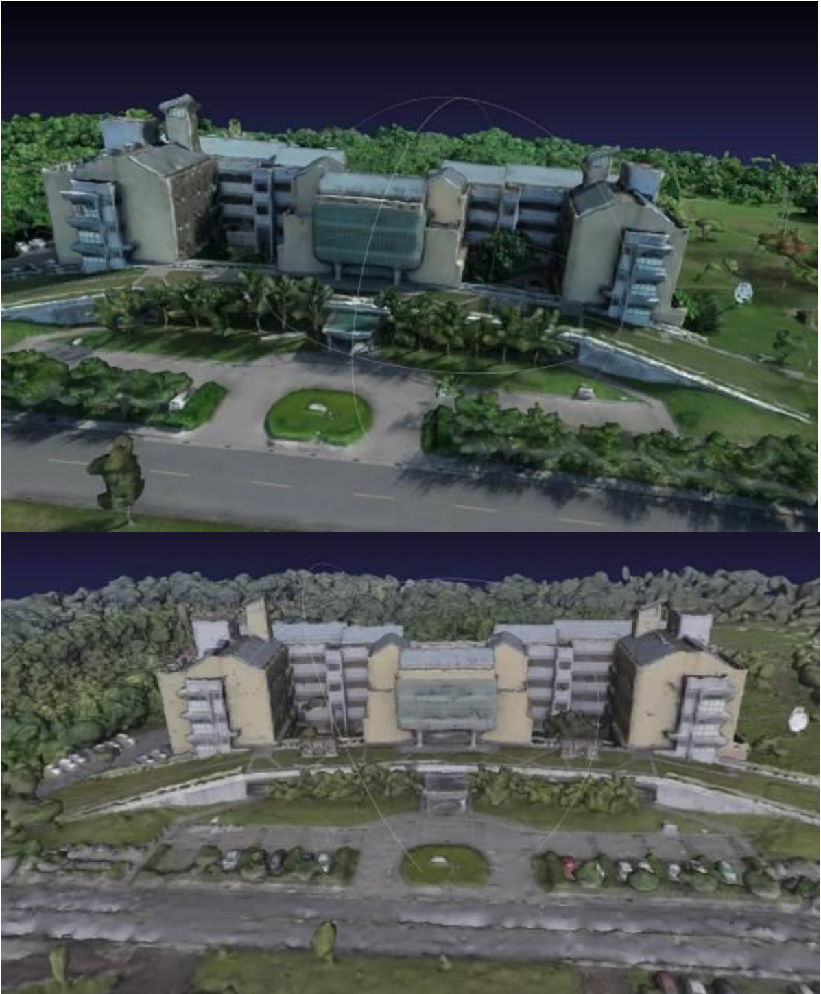
圖 6、圖 5 之 3D 模型放大後，細部扭曲浮現(上圖)與圖 4 之 3D 模型放大(下圖)相差不大。
