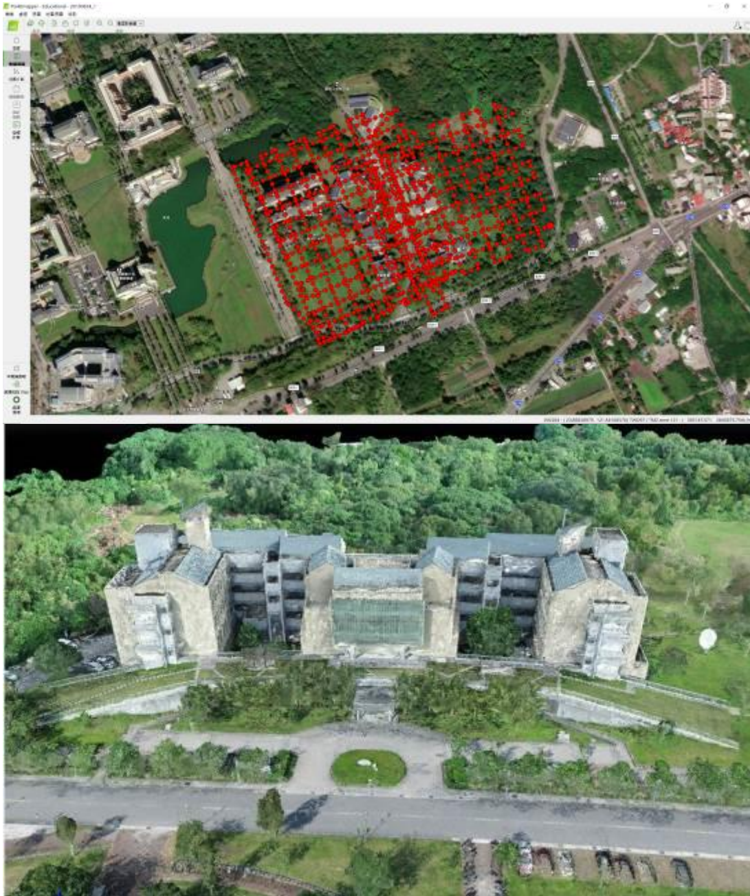
圖 2、DJI Phantom 4 RTK 無人機飛行路線(上圖)與東華大學環境學院 LOD 1 / LOD 2 模型(下圖)
