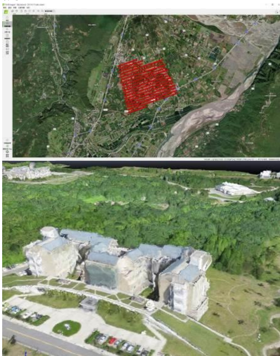
圖 1、eBee 定翼無人機飛行路線(上圖)與東華大學環境學院 LOD 1 / LOD 2 模型(下圖)
