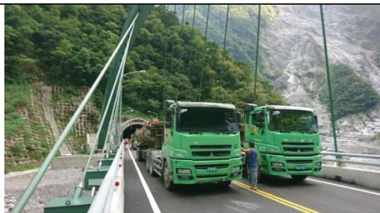
照片 2.11 卸載留置 4 部卡車在橋梁上。
