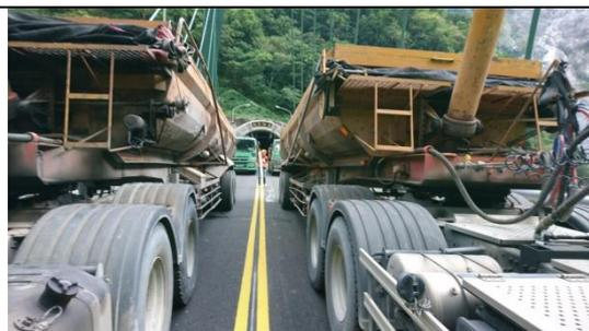
照片 2.10 卸載留置 6 部卡車在橋梁上
