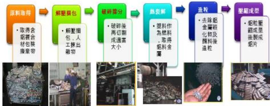
圖 1、熱裂解法回收金屬鋁<sup>[6]</sup>
