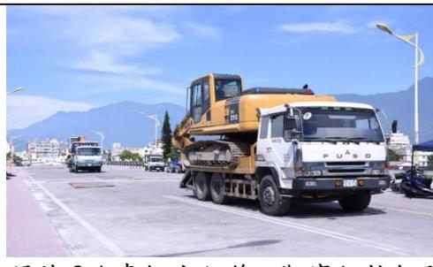
照片 3.4 車輛定位後，觀察鉸接板開裂情況之載重位置
