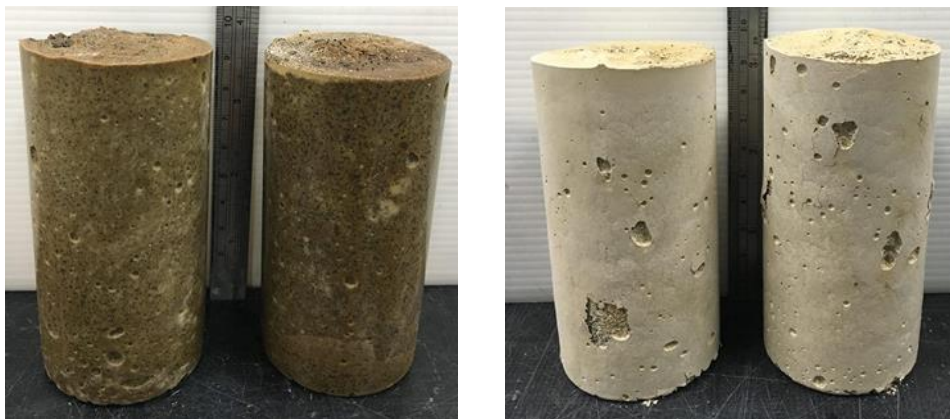
圖10 耐候性試驗前後固化體外觀(左為試驗前，右為試驗後)
