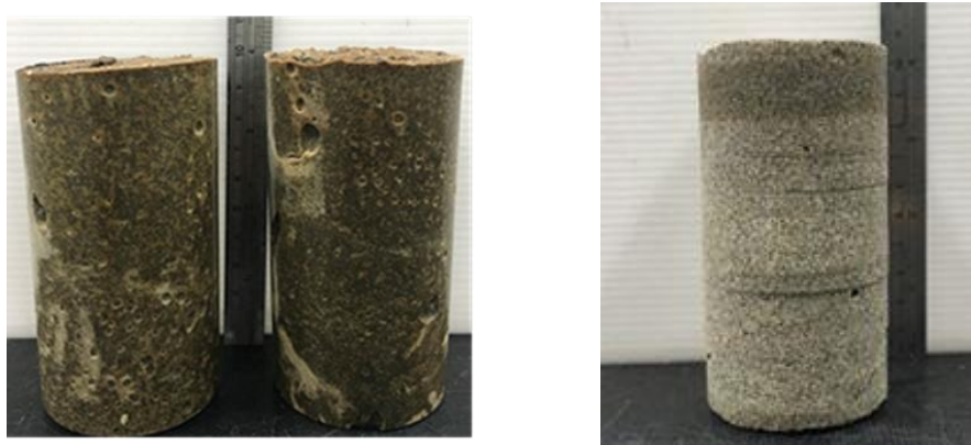
圖7 28天固化體(左)與鑽心取樣固化體(右)外觀
