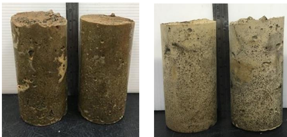
圖10 耐水性試驗前後固化體外觀(左為試驗前, 右為試驗後)
