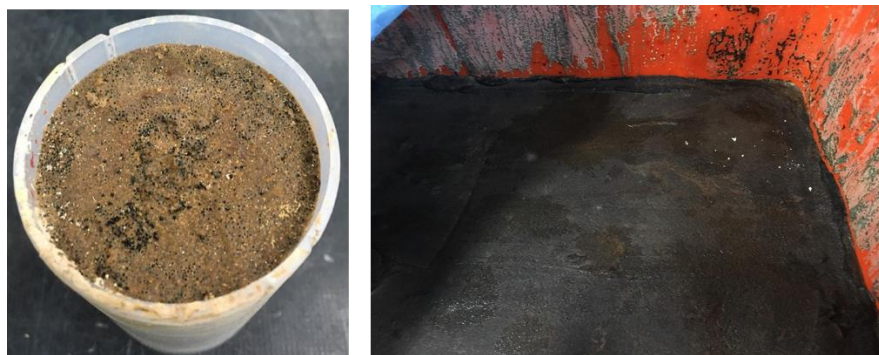
圖8 模擬實廠大型固化體之自由水
