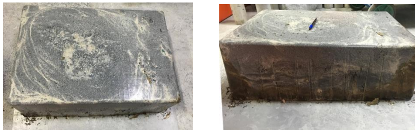
圖5 模擬實廠大型固化體外觀
