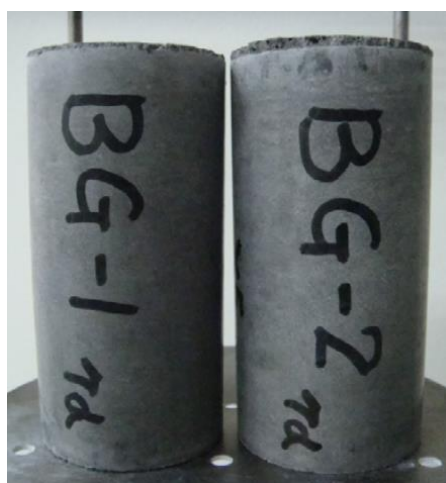
熱壓膨脹試驗前
