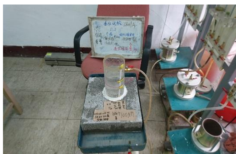
圖3-3 變水頭試驗之試驗裝置
