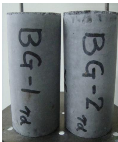
熱壓膨脹試驗後
