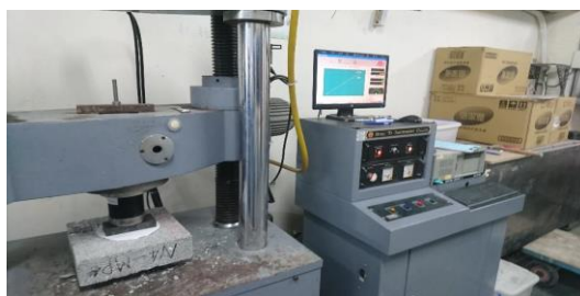
圖3-5 透水磚成品抗壓試驗之裝置
