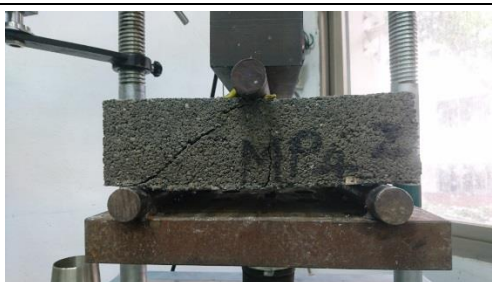
圖3-4 試體抗彎試驗示意圖(支承跨距24cm)
