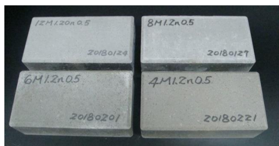
圖 9 4M、6M、8M、12M 冷壓型 GP BOF 高壓地磚成品
