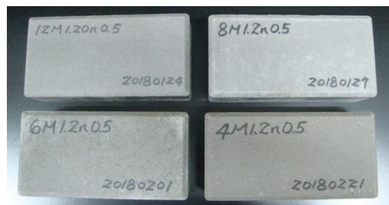
圖 9 4M、6M、8M、12M 冷壓型 GP BOF 高壓地磚成品
