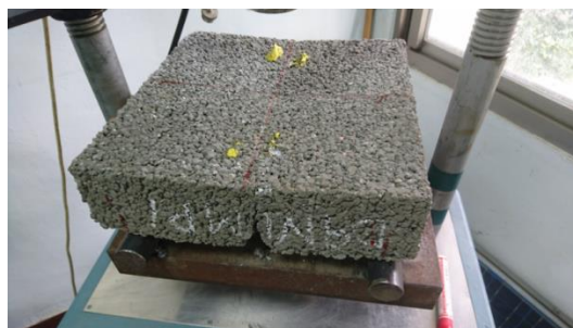
圖 4.3-1 D9-N1-MP1 試體破壞模式
