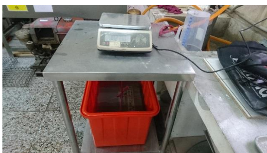
圖3-2 孔隙率試驗裝置
