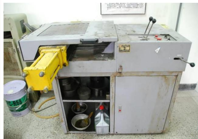
鋼筋彎曲機
