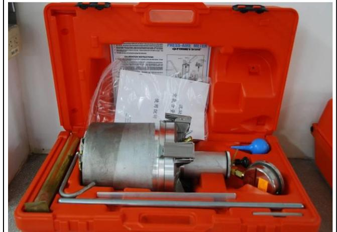
混凝土空氣含量試驗儀
