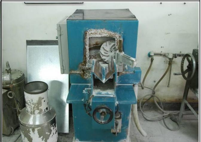
混凝土圓柱試體磨平機
