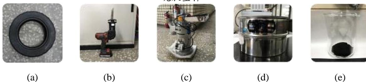
Figure 4 廢輪胎製備過程。(a)廢輪胎，(b)切割機，(c)破碎機，(d) 50 mesh 篩網，(e)廢輪胎粉。
