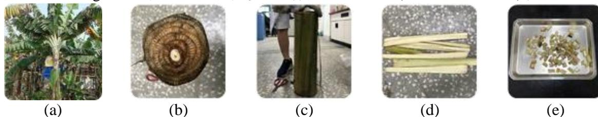
Figure 3 香蕉莖稈製備過程。(a)香蕉莖稈，(b)莖稈剖面，(c)莖稈側面，(d)條狀莖稈，(e)
