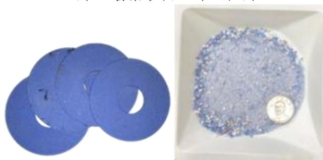
圖 2 氧化鋁廢棄砂輪破碎前後圖
