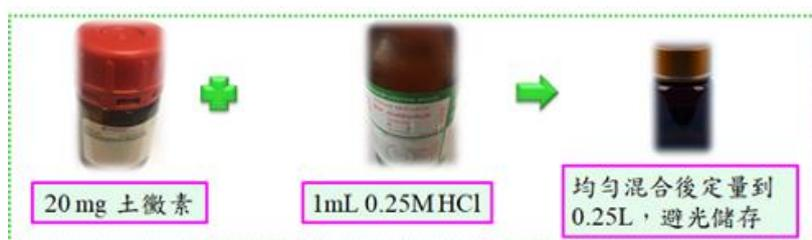
圖 4 模擬廢水製備流程圖
