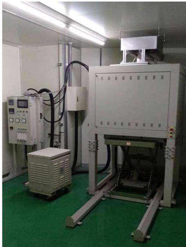
圖6 脫脂燒成連續爐的爐頂有自動開關，可以設定在脫脂時開啟，燒成時關閉，並通入不同氣氛
