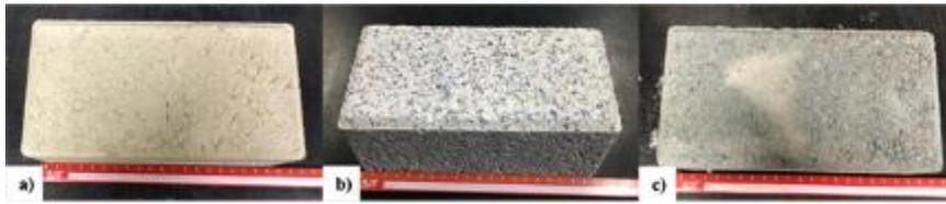
圖 7 不同種類之氧化鋁廢棄砂輪製備無機聚合冷壓磚之外觀圖，(a)含硫氧化鋁；(b)氧化鋁；(c)碳化矽
