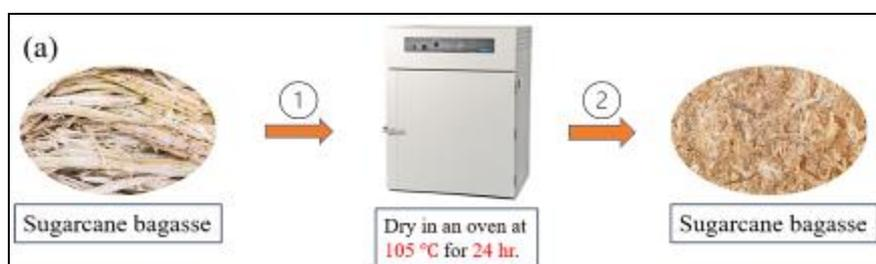
圖 2. 電極製作流程 (a)甘蔗渣的製備
